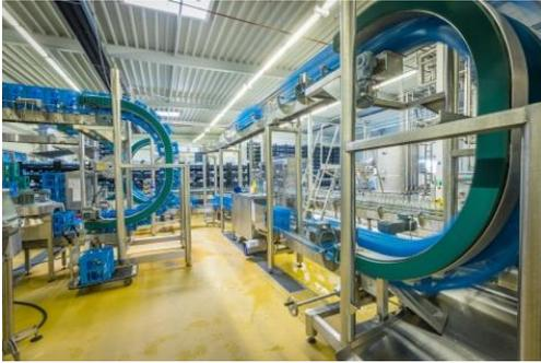
Die Anlage dient zur Abfüllung von Mehrweg-Glasflaschen 0,275 l, 0,33 l, 0,5 l, 0,75 l und 1,0 l mit stillem, medium oder classic Bio-Mineralwasser (ca. 4 g CO<sub>2</sub>/Liter bzw. 5,5 g CO<sub>2</sub>/Liter).
