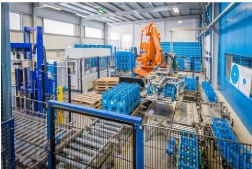
Folgend werden die Flaschen in einem 30stelligen Gegendruckfüller gefüllt und mit desinfizierten Kronenkorken bzw. Schraubverschlüssen verschlossen. Die gefüllten Flaschen werden etikettiert, mit einem MHD versehen und automatisch in die gewaschenen Kunststoffkästen verpackt. Anschließend bildet ein Packroboter aus den einzelnen Kisten die Vollgutpaletten.
